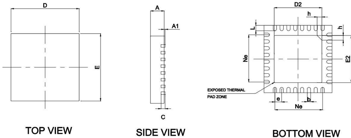
图 4-2 LKS32MC052K6Q8 封装图示
