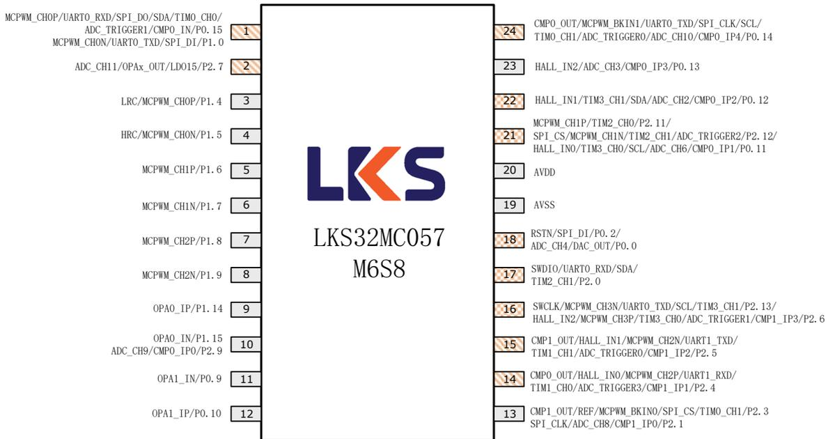
图 3-3 LKS32MC057M6S8 管脚分布图
