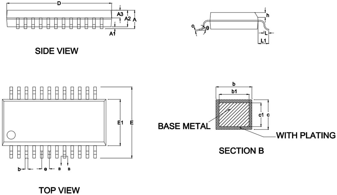
图 4-3 LKS32MC057M6S8 封装图示
