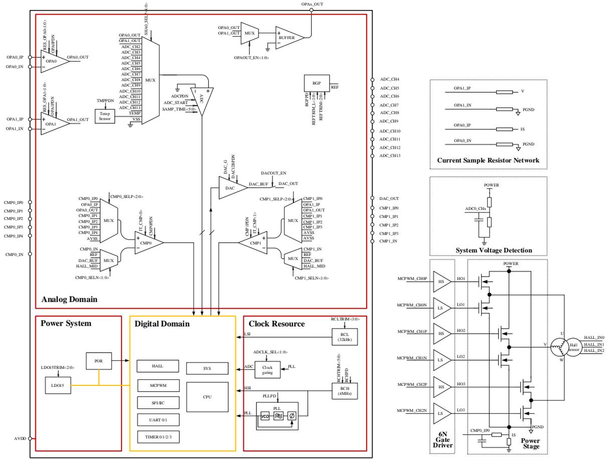
图 1-3 LKS32MC05x 矢量正弦控制系统简化原理图
