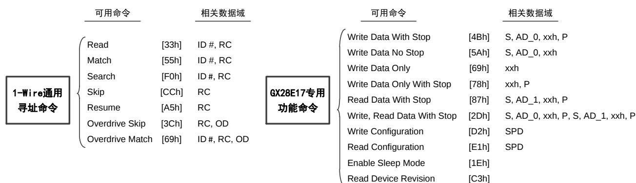
图 1 GX28E17 的命令层级架构
