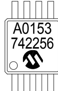
8-Lead SOIC (3.90 mm)
