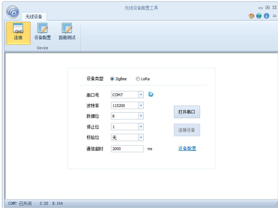
图 5.7 串口参数配置
