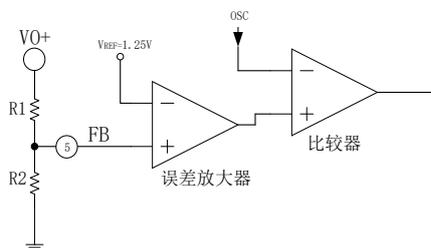
图 8.5 EG1195S 输出电压调整电路
