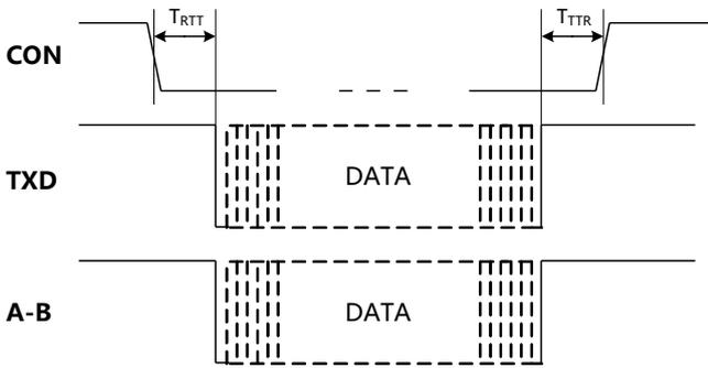
图 1. TDx01D485H-E模块数据发送时序图
