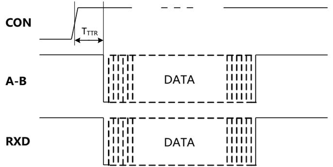
图 2. TDx01D485H-E模块数据接收时序图
