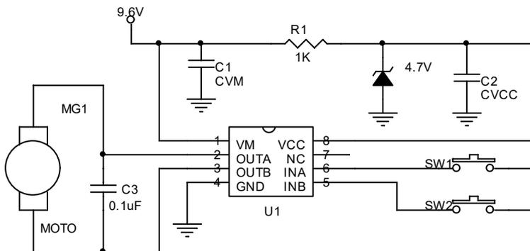
注：如图在 3V 应用中建议 CVM 电容至少用一个 0.1uF；在 4.5V 应用中至少用一个 1uF；在 6V 应用中至少用一个 4.7uF；在 9V 应用中至少用一个 22uF。均为使用贴片电容靠近 IC 之 VDD 管脚放置且电容的负极和 IC 的 GND 端之间的连线也需尽量短。即不要电容虽然近，但布线、走线却绕得很远。当使用大电解插件电容时，建议再并一个 0.1uF 贴片电容于 TC2466H 之 VM 脚上。参考下图。
