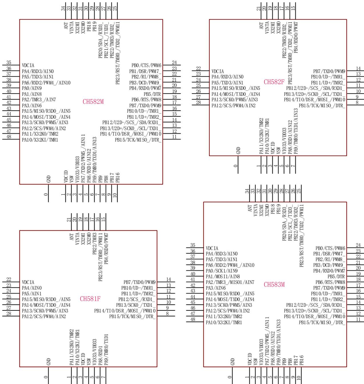
图 1-1 CH582M/CH583M(QFN48) 和 CH582F/CH581F(QFN28) 封装引脚排列
