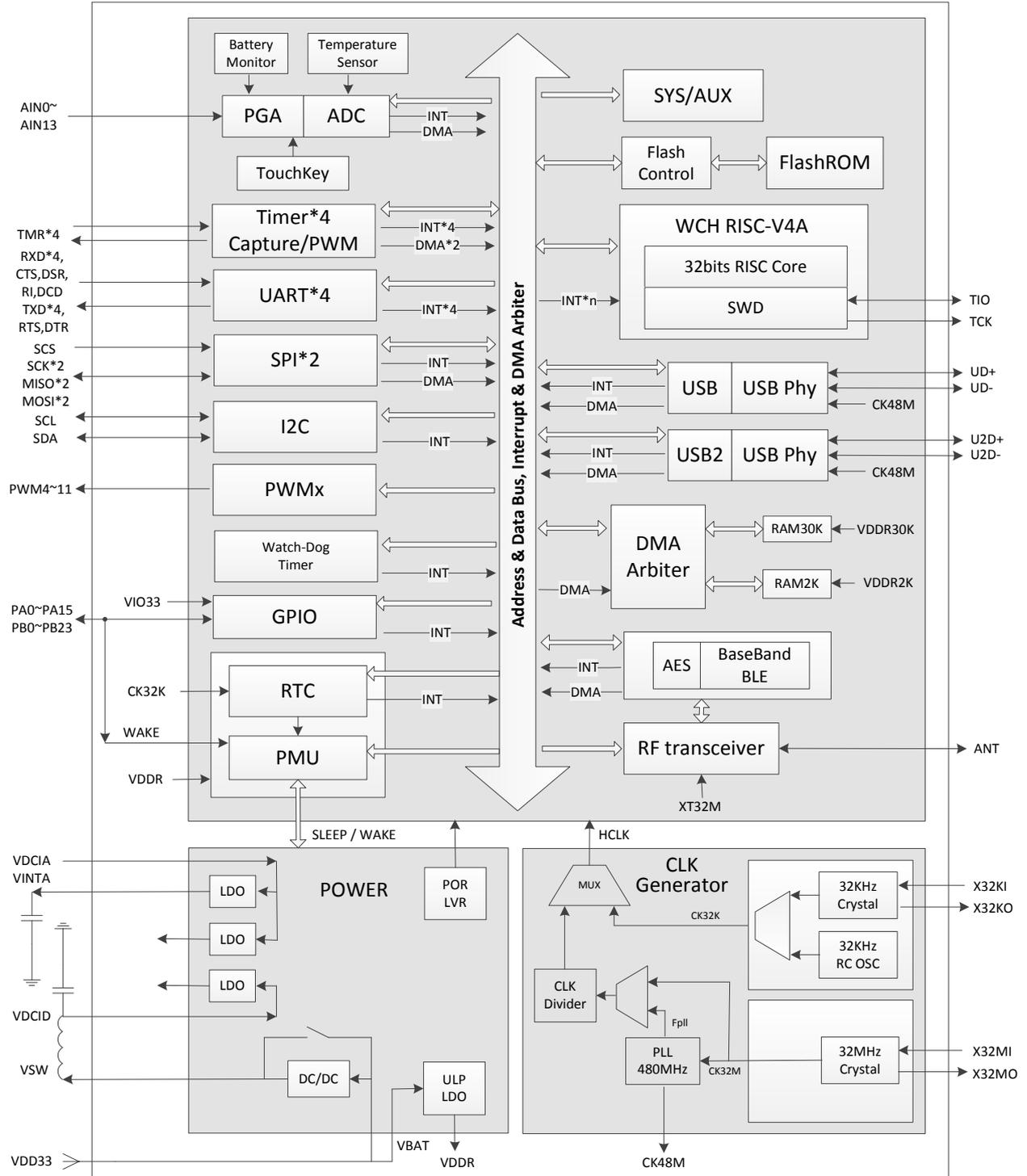
图 2-1 CH583 内部结构框图
