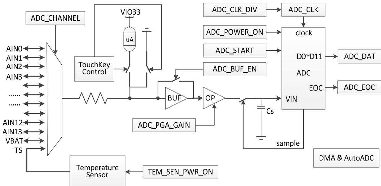
图 15-1 ADC 结构图
