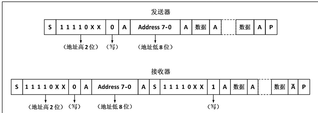
6) 发送模式时，主设备内部的移位寄存器将数据从数据寄存器发送到 SDA 线上，当主设备接收到 ACK 时，状态寄存器 1 (R16\_I2C\_STAR1) 的 TxE 被置位，如果 ITEVTEN 和 ITBUFEN 被置位，还会产生中断。向数据寄存器写入数据将会清除 TxE 位。
