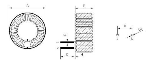
注:产品绕线均匀平整,绕完后浸油烘干
