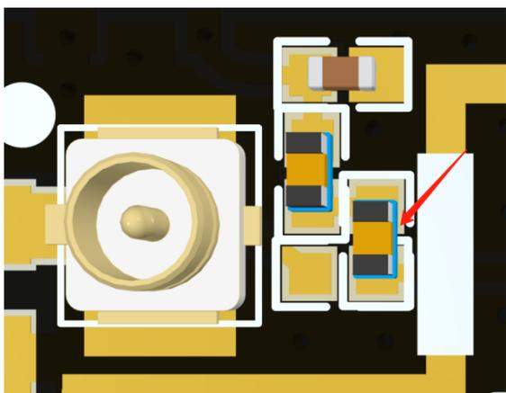
图 5-3 板载 PCB 天线跳转电阻连接
