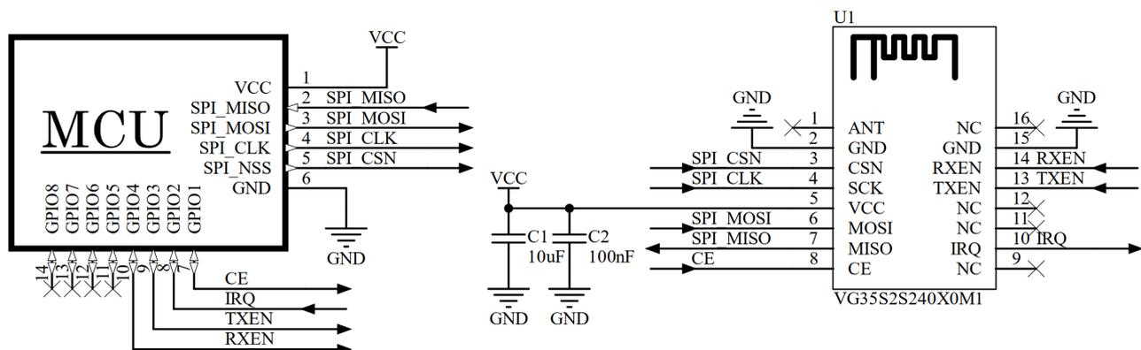
图 5-2 编程开发硬件连接 (板载 PCB 天线)
