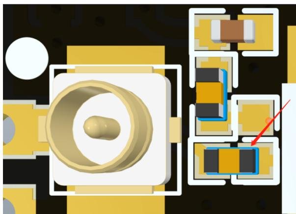
图 5-4 IPEX-1 座子或邮票半孔跳转电阻连接
