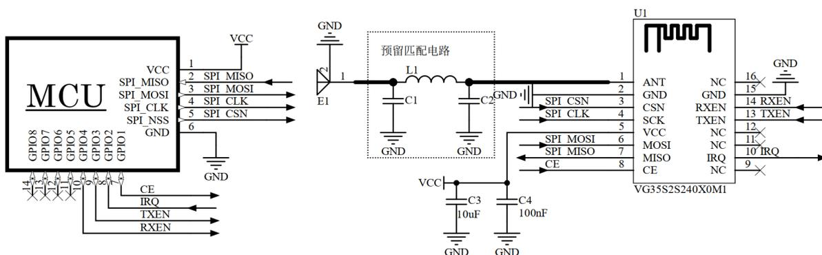
图 5-1 编程开发硬件连接 (邮票孔外置天线)
