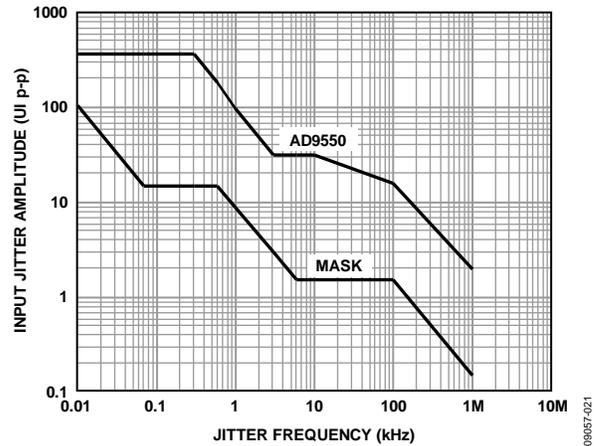
Figure 25. Jitter Tolerance
