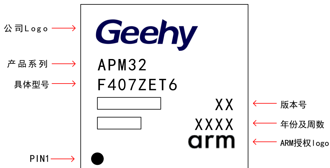
图 22 LQFP144 -144 引脚，20 x20mm 示意图
