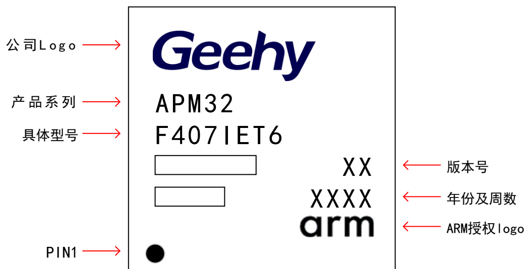
图 19 LQFP176 -176 引脚，24 x24 mm 示意图
