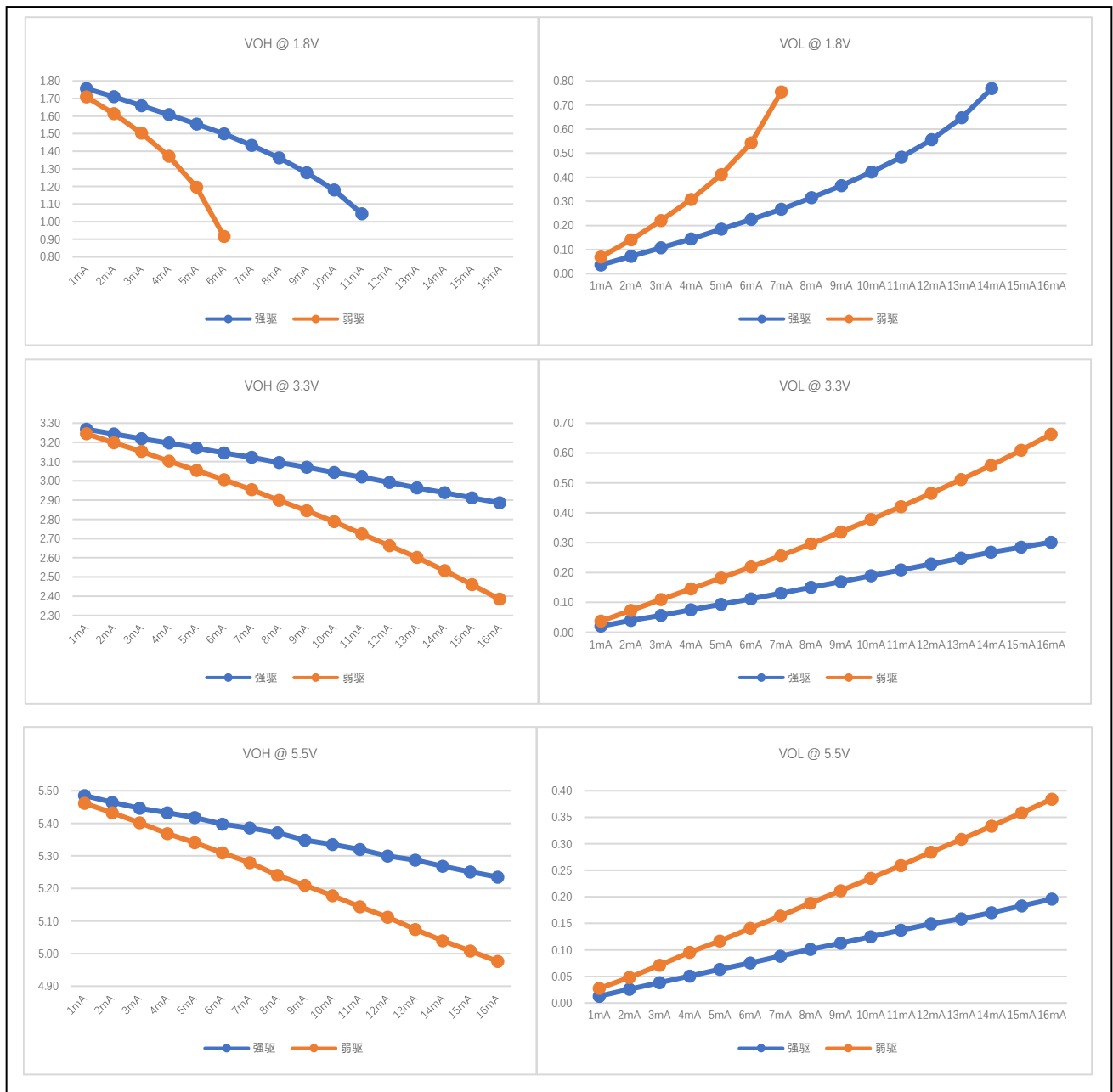
图 7-2 输出端口 VOH/VOL 实测曲线
