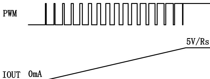
3.2 共地型: 0/4-20mA输出 (共地型三线制), Q1选择TO252封装的NPN, 作为功率管承受4-20mA所产生发热。
