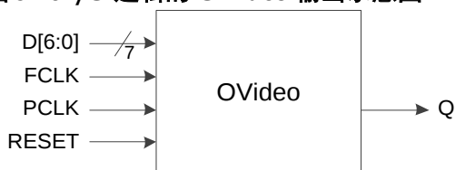
图 3-18 I/O 逻辑的 OVideo 输出示意图
