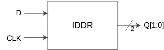
图 3-13 I/O 逻辑的 DDR 输入示意图
