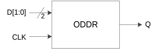
图 3-14 I/O 逻辑的 DDR 输出示意图
