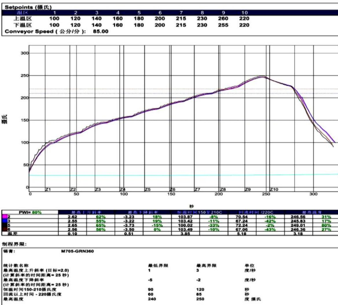
图 19 回流焊温度曲线
