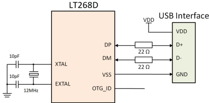
图 8-11: LT268D 连接到 USB 的应用电路
