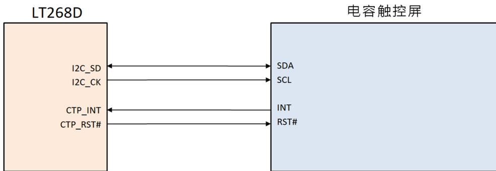
图 8-7: LT268D 连接到电容式触控屏
