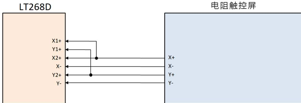
图 8-6: LT268D 连接到电阻式触控屏
