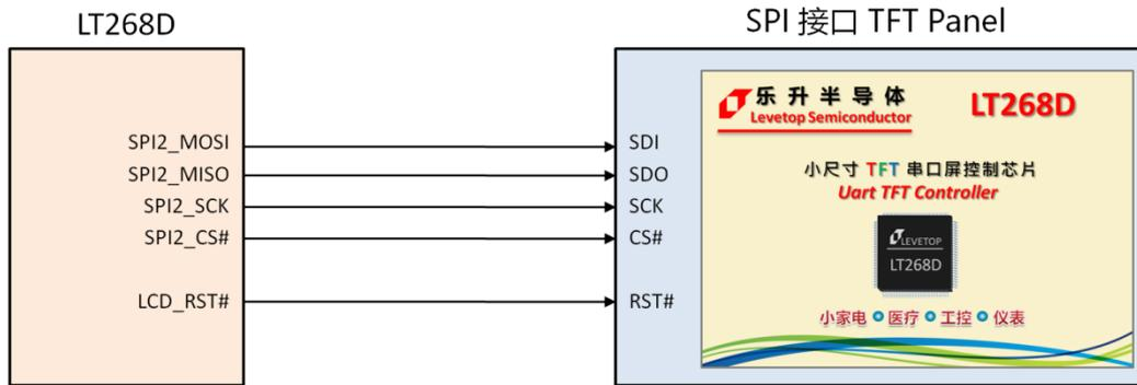
图 8-4: LT268D 与 SPI 接口的 MCU 屏连接
