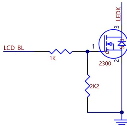
图 8-8: LCD 背光控制参考原理图
