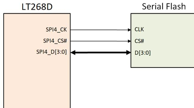
图 8-5: LT268D 连接到 SPI Flash 的应用电路
