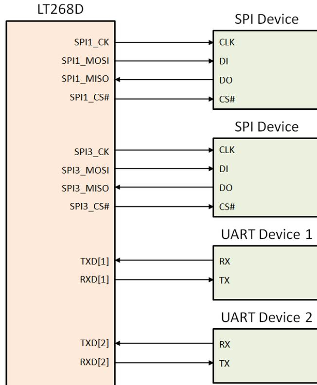
图 8-12: 额外的 SPI、Uart 接口参考原理图
