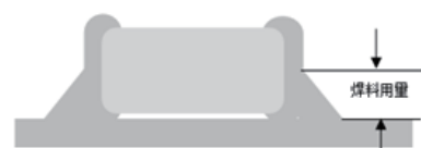
C.使用烙铁返修时的最佳焊料量
