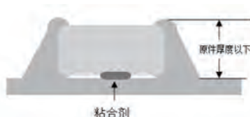
B.波峰焊接的最佳焊料用量
