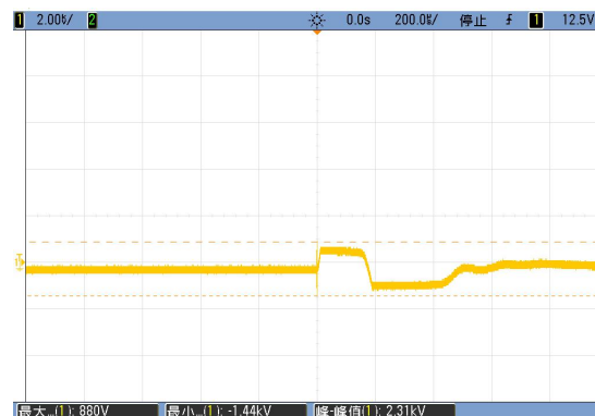
输出端电压波形(共模 0.88KV)
