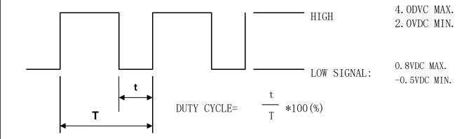
SIGNAL VOLTAGE RANGE 控制电压输入范围:-0.5~+4.0VDC
