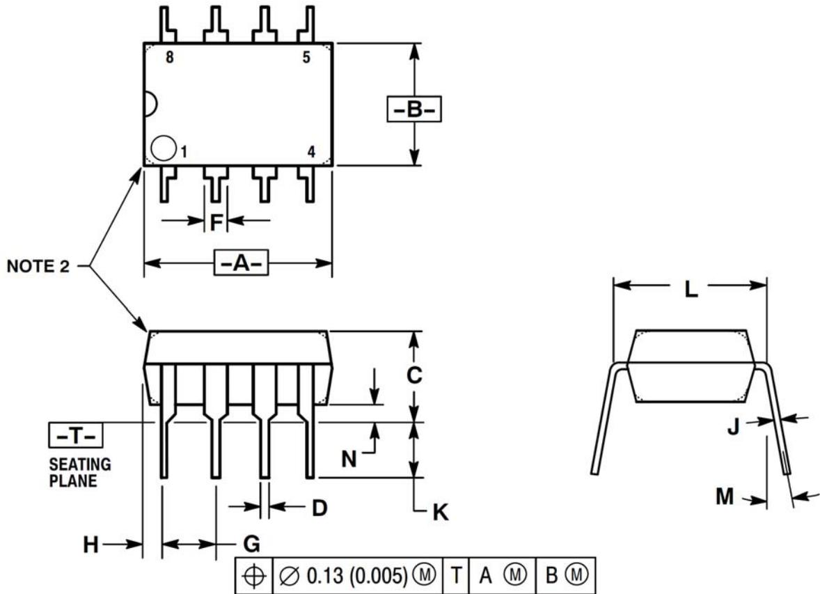
注：1. L尺寸为引脚平行时的尺寸；2. 外形有圆形角和方形角两种。
