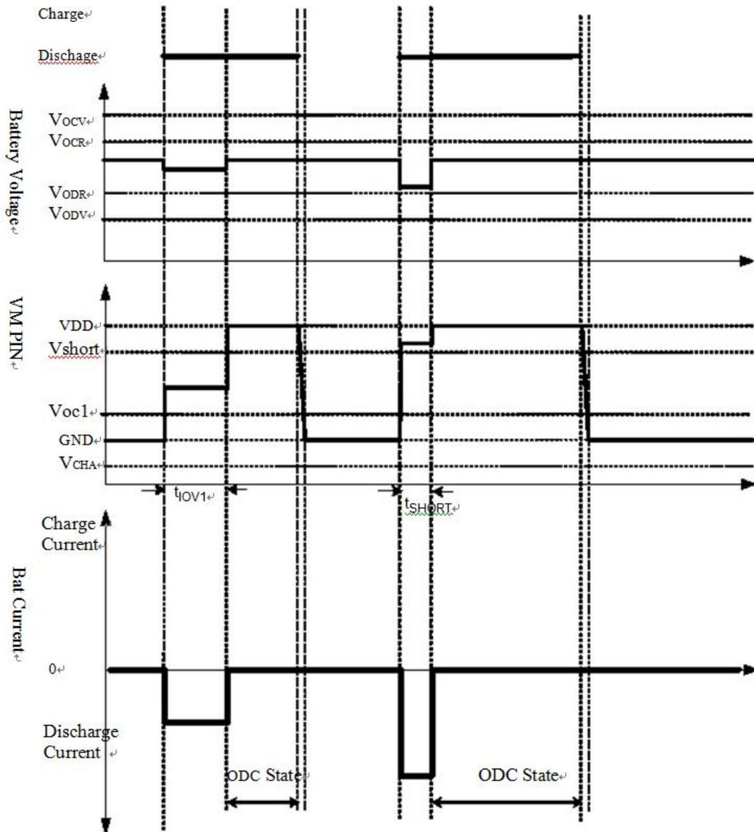
Figure 4. 放电过流和正常工作时序图
