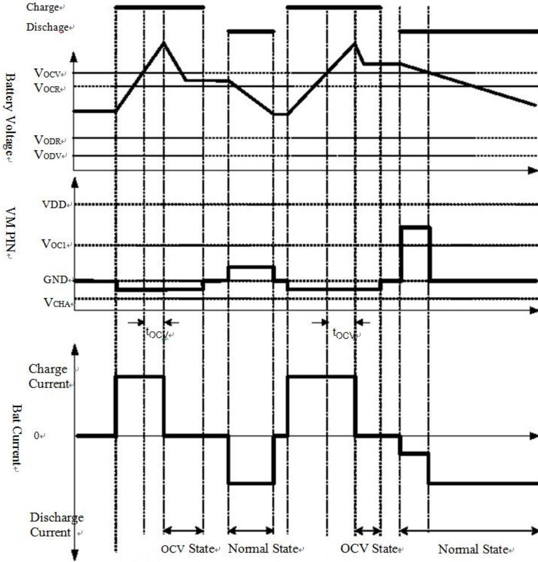
Figure 2. 充电，放电，正常工作时序图
