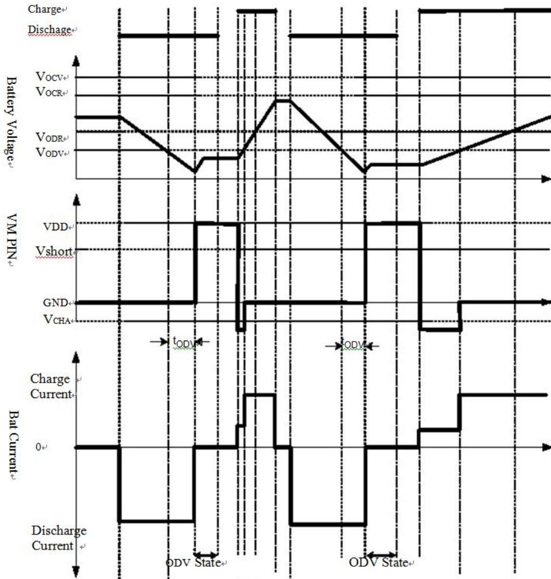
Figure 3. 过放, 充电和正常工作时序图
