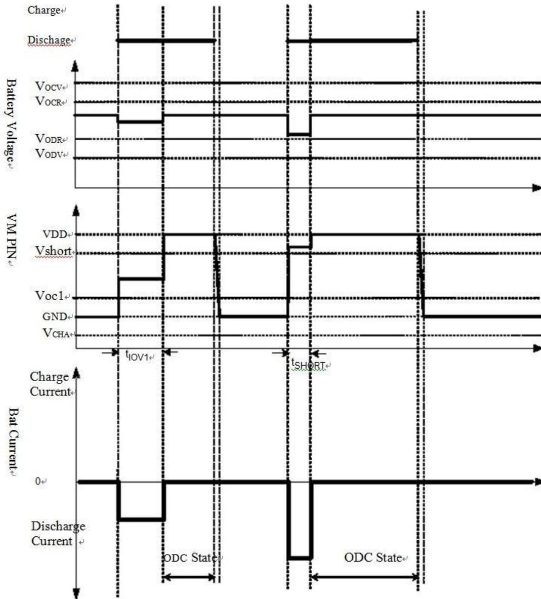
Figure 6. 放电过流和正常工作时序图
