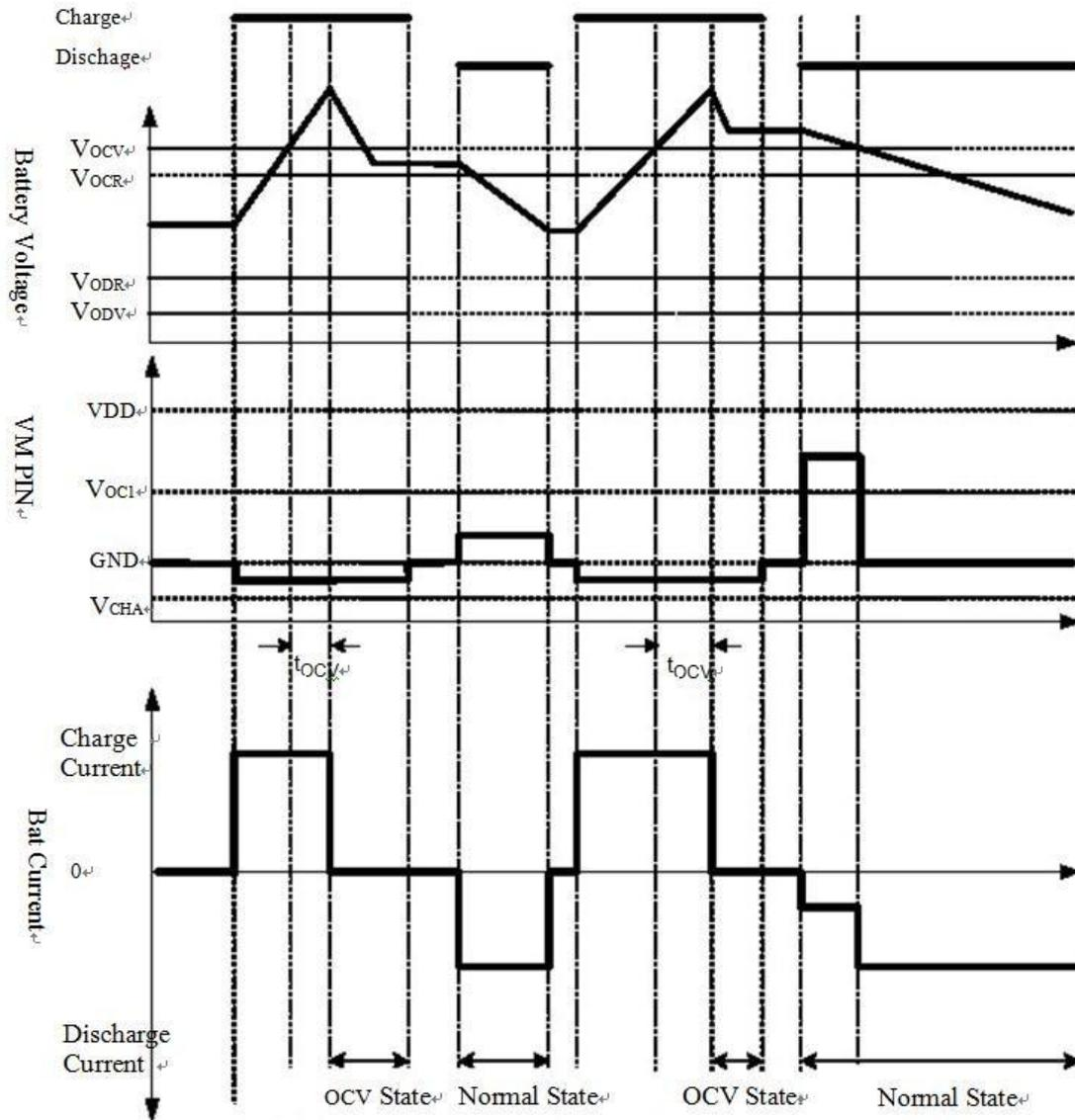
Figure 3. 充电，放电，正常工作时序图
