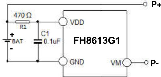
**推荐元件参数：**电阻 R1 阻值 100Ω-1kΩ，电容 C1 容值10nF-1μF；
