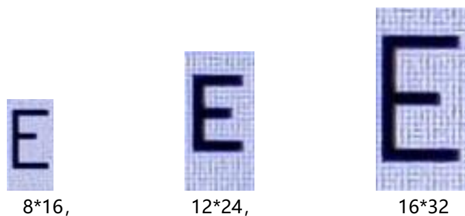
图 16-1B: 不同字符大小的 ASCII 范例 (8*16 / 12*24 / 16*32)
