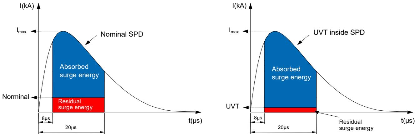
经过多次试验的验证，完成了电路模型的建立，推出超低压触发方案（UVT），应用于新款拓士浪涌抑制器中，大大提高了浪涌防护效率，对被保护设备起到了很好的浪涌防护效果。
