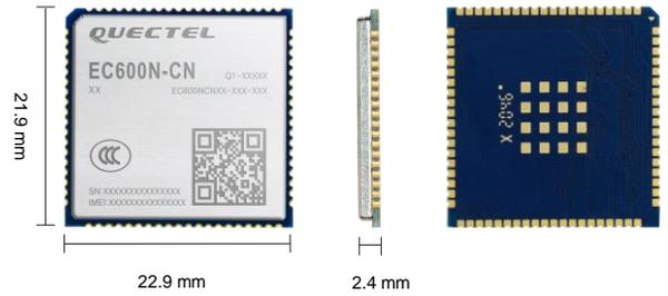
EC600N-CN是移远通信专为M2M和IoT领域而设计的LTE Cat 1无线通信模块，支持最大下行速率10 Mbps和最大上行速率5 Mbps，超小封装，超高性价比。同时，EC600N-CN在封装上兼容EC600S-CN模块。
