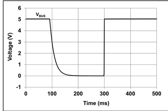
**FIGURE 2-4:**  $V_{BUS}$  Discharge Behavior.
