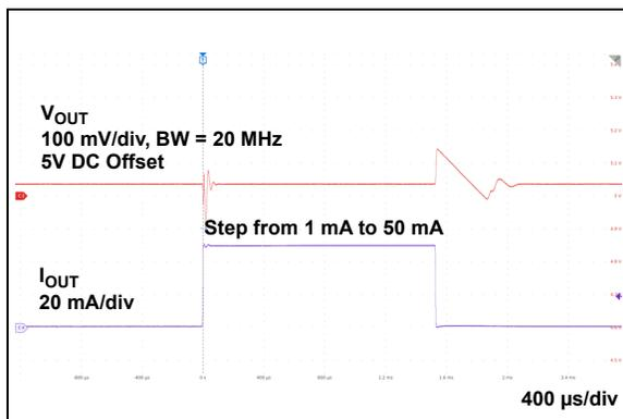
**FIGURE 2-25:** Dynamic Load Step ( $V_R = 5.0\text{V}$ ).
