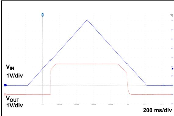
**FIGURE 2-18:** UVLO ( $V_R = 3.3\text{V}$ ).
