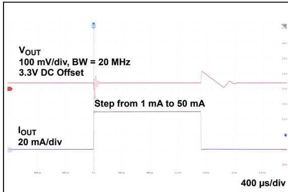
**FIGURE 2-24:** Dynamic Load Step ( $V_R = 3.3\text{V}$ ).
