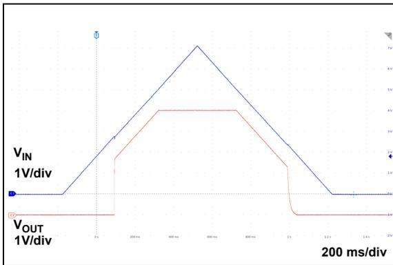
**FIGURE 2-19:** UVLO ( $V_R = 5\text{V}$ ).
