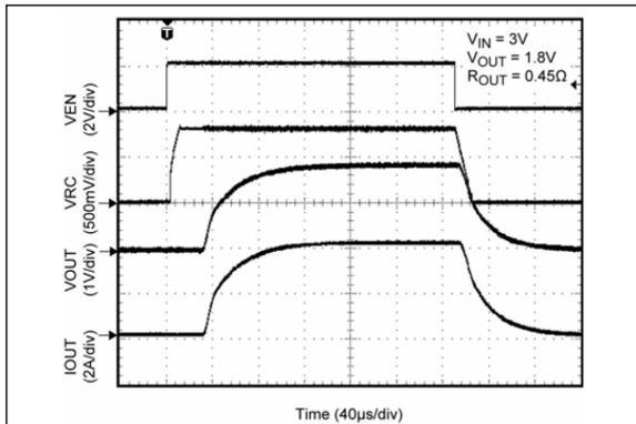
**FIGURE 2-20:** Start-Up ( $C_{RC} = 0 \text{ nF}$ ).
