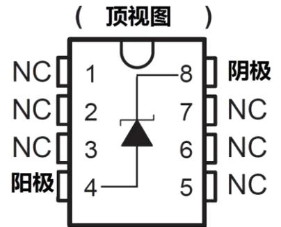
图 4 SOP8 管脚图
