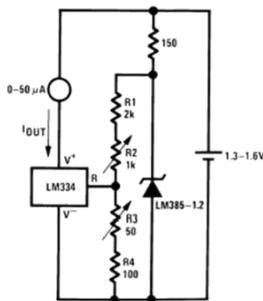
将 LM385 短路, 调整 R3, 使  $I_{OUT} = temp @ 1.8\mu A/^\circ K$ ; 解除短接, 调整 R2, 读取正确的数值, 单位为°F。
