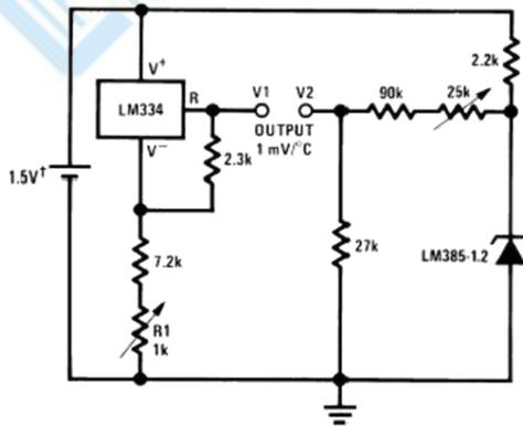
调整 R1, 使  $V1 = \text{temp}@1\text{mV}/^\circ\text{K}$ ; 调整 V2 至 273.2mV。
