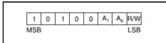
**Figure 5. Byte Write**
