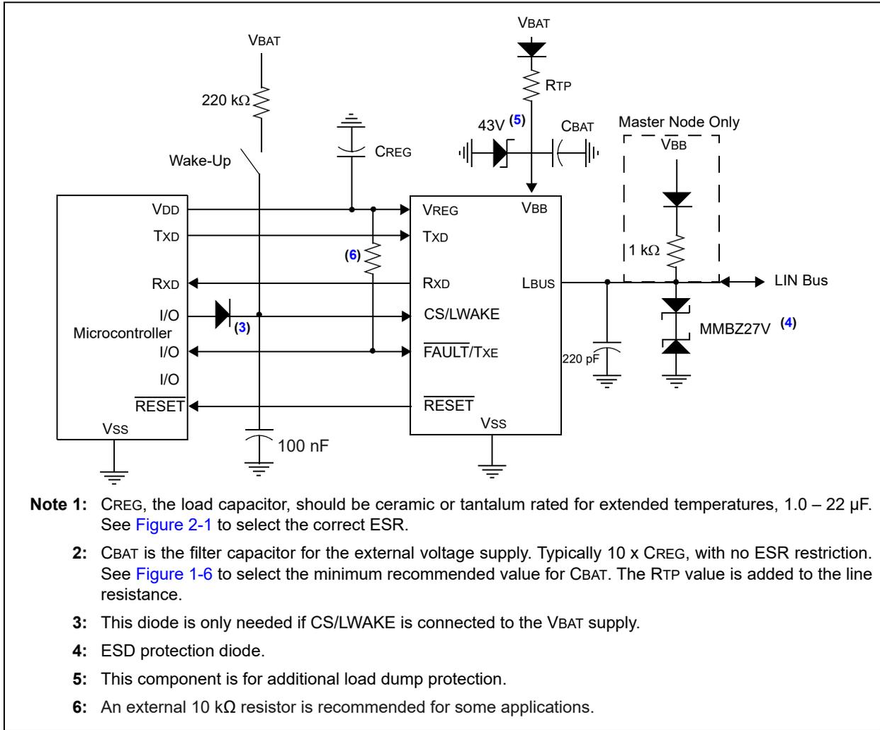
**FIGURE 1-8: TYPICAL LIN NETWORK CONFIGURATION**
