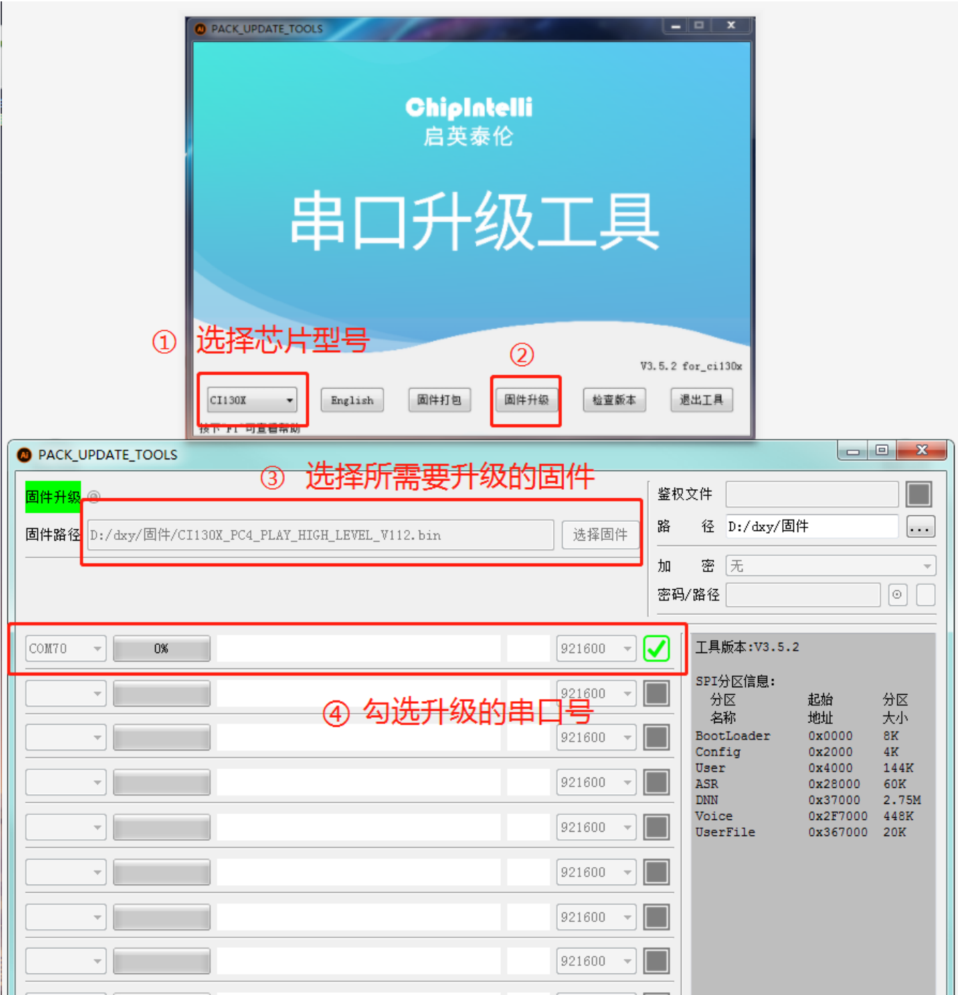
图14 固件烧录工具示意图
