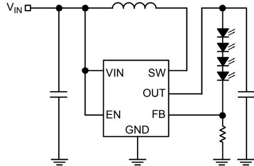
**Figure 3. MLF<sup>®</sup> Package OVP Circuit**
