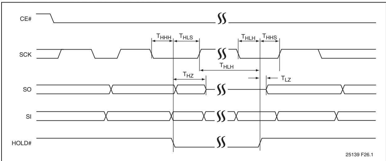
**FIGURE 6-6: STATUS REGISTER WRITE TIMING**
