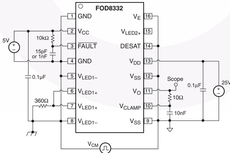
图 50. 共模低电平 (CML) LED1 关测试电路
