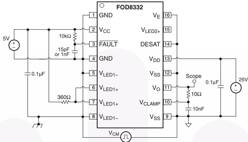
图 51. 共模高电平 (CMH) LED1 开测试电路
