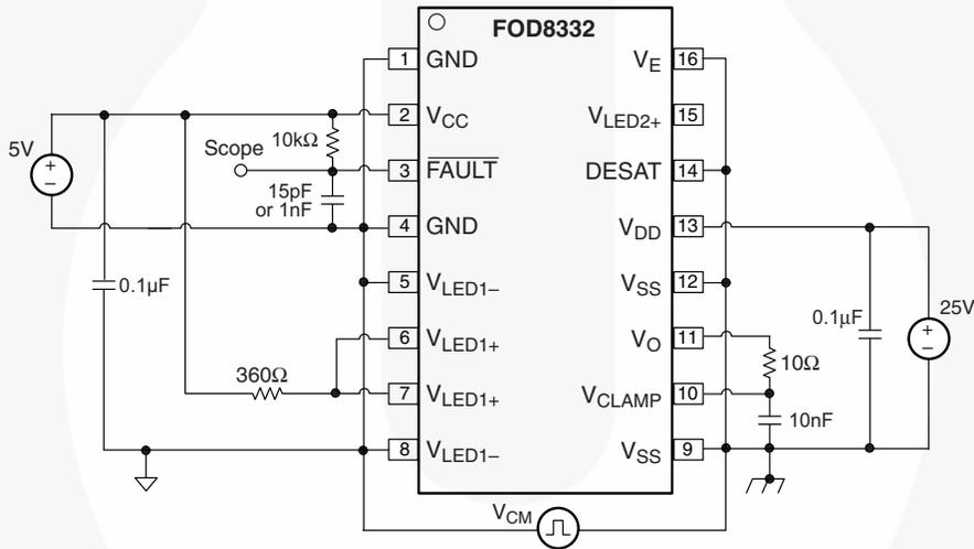
图 52. 共模高电平 (CMH) LED2 关测试电路
