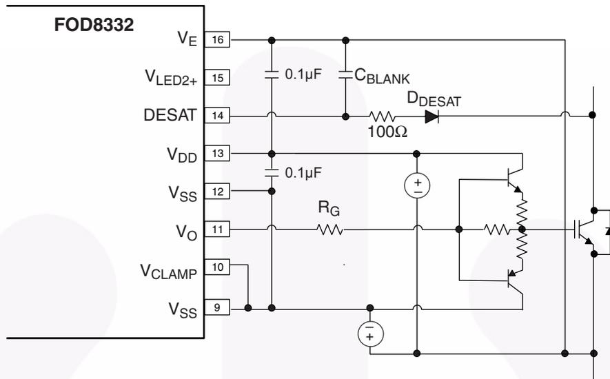
图 58. 输出增压器级可提高输出驱动电流
