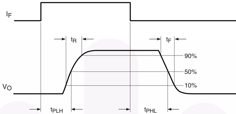
图 3.  $t_{PLH}$ 、 $t_{PHL}$ 、 $t_R$  和  $t_F$  时序图
