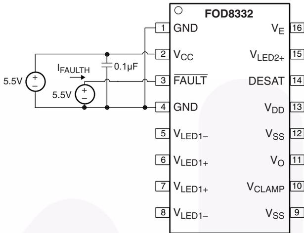
图 45. 故障高电平输出电流 ( $I_{\text{FAULTH}}$ ) 测试电路
