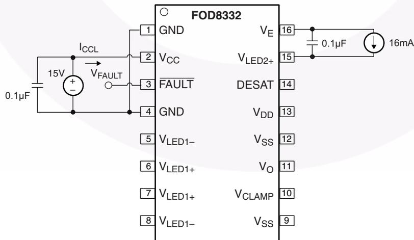
图 44. 故障低电平电源电流 ( $I_{CCL}$ ) 测试电路
