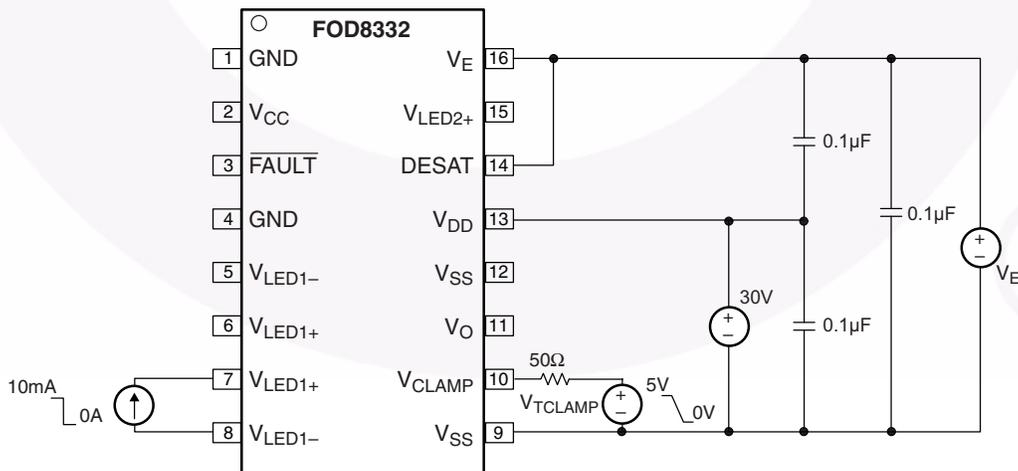
图 41. 钳位阈值电压 ( $V_{CLAMP\_THRES}$ ) 测试电路
