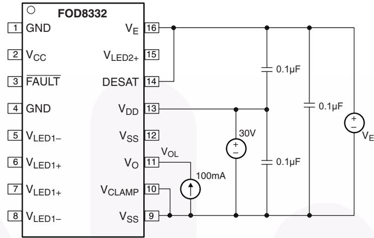
图 36. 低电平输出电压 ( $I_{OL}$ ) 测试电路
