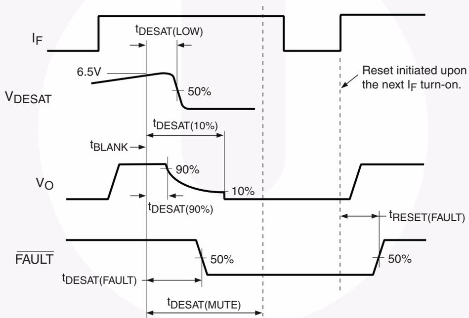
图 4.  $V_{DESAT}$ 、 $V_O$  和  $\overline{FAULT}$  时序波形的定义
