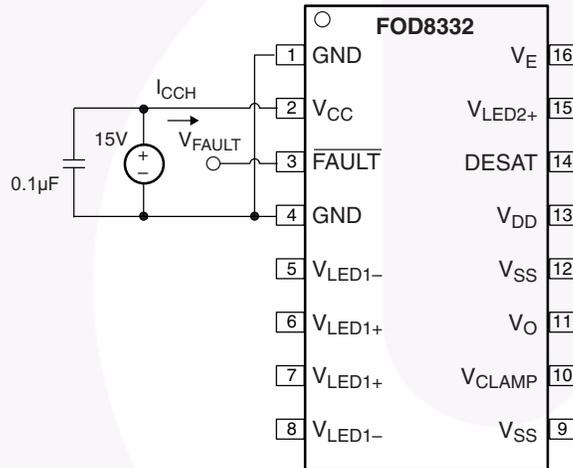
图 43. 故障高电平电源电流 ( $I_{CCH}$ ) 测试电路
