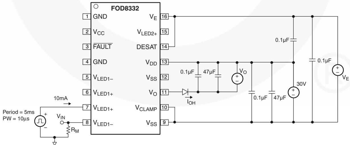
图 32. 高电平输出电流 ( $I_{OH}$ ) 测试电路
