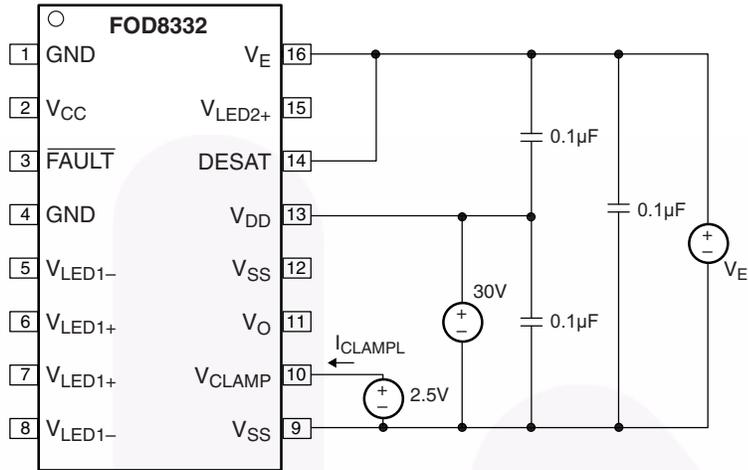
图 42. 箝位低电平灌电流 ( $I_{CLAMPL}$ ) 测试电路
