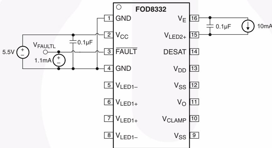
图 46. 故障低电平输出电压 ( $V_{\text{FAULTL}}$ ) 测试电路
