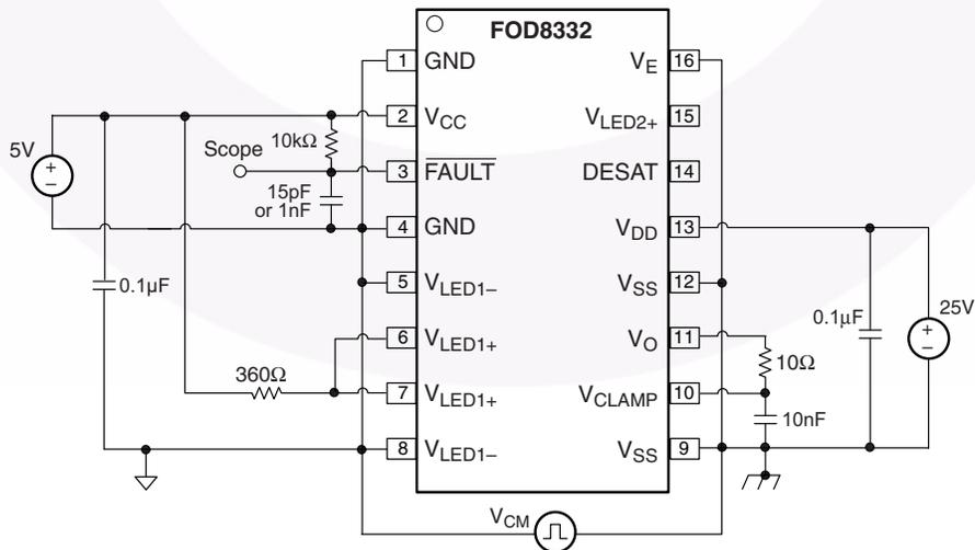
图 53. 共模高电平 (CML) LED2 开测试电路
