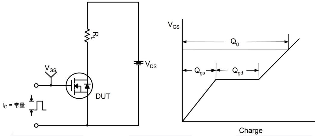
图 13. 栅极电荷测试电路与波形
