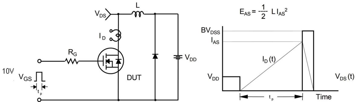
图 15. 非箝位电感开关测试电路与波形
