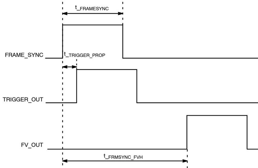
**Figure 16. Frame\_Sync Diagram**
