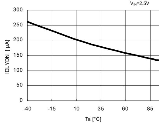
**37) DELAY Detector Threshold vs. Temperature**
