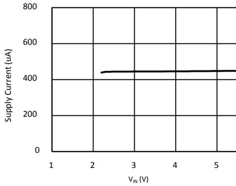
$f_{REQ} = 700\text{kHz}$ ,  $T_a = 25^\circ\text{C}$
