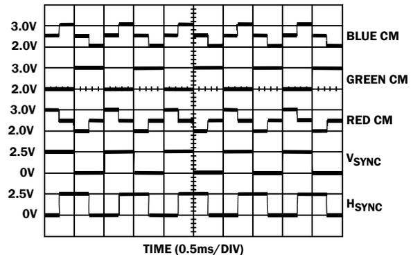
**FIGURE 13. H AND V SYNC SIGNAL ENCODING**
