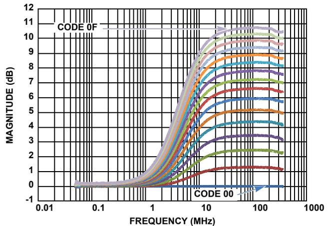
FIGURE 7. FREQUENCY RESPONSE vs 6MHz BITS 3:0
