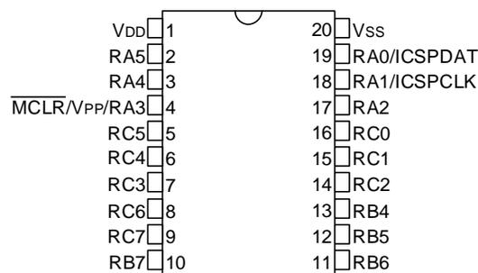
Figure 2-4. 20-Pin QFN
