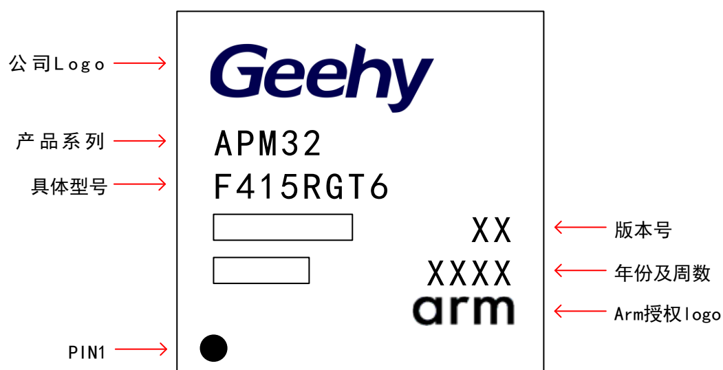
图 28 LQFP64 - 64 引脚, 10 x 10mm 示意图
