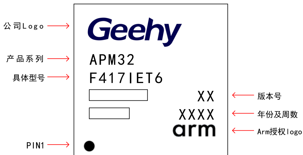
图 19 LQFP176 -176 引脚，24 x24 mm 示意图
