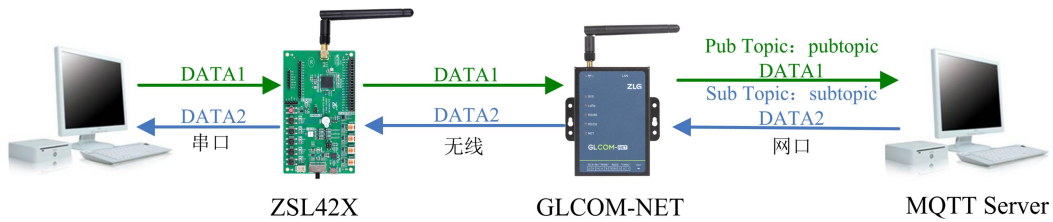
图 4.7 无线与 MQTT 透传应用示意图
