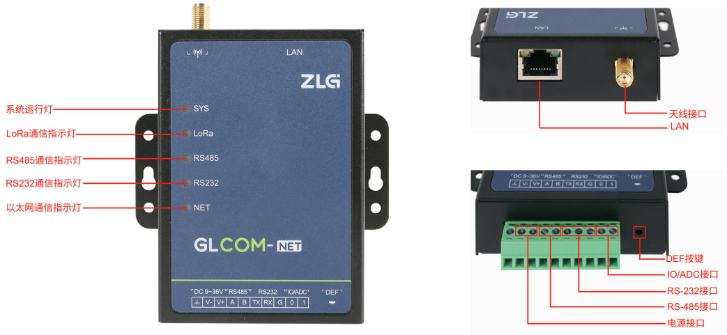
图 2.1 GLCOM-NET 接口排列示意图
