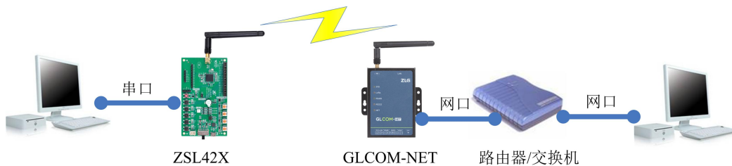
图 3.1 硬件连接示意图
