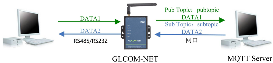
图 4.32 串口与 MQTT 透传应用示意图
