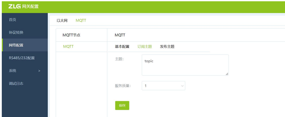
图 5.16 MQTT 订阅主题配置
