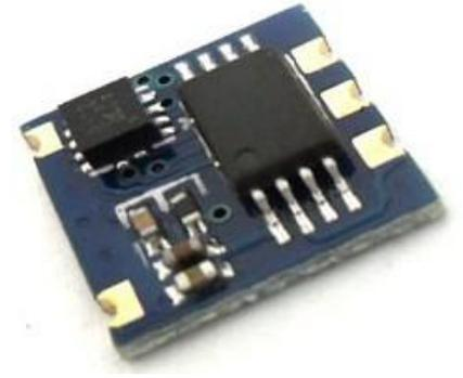
STP101M 是一套 3D 计步功能模块。采用脉冲接口输出, 模块使用了一个高性能的计步器主控 MCU 和一个高灵敏度的 G Sensor, 结合高精度的 3D 计步算法, 使其在任何方向都可以精确计步。此模块具有小体积、低功耗, 高精度等特点。模块提供了简单的脉冲输出接口。使其能很方便地应用于 3D 计步器、USB 多功能计步器、卡片计步器, 以及各种嵌入计步功能的系统。
