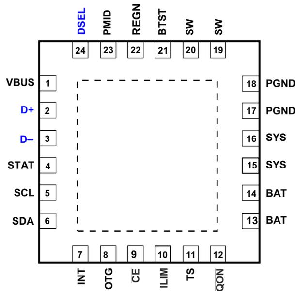
图 7-1. RTW Package 24-Pin WQFN Top View
