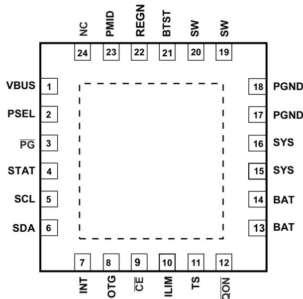
图 7-2. RTW Package 24-Pin WQFN Top View
