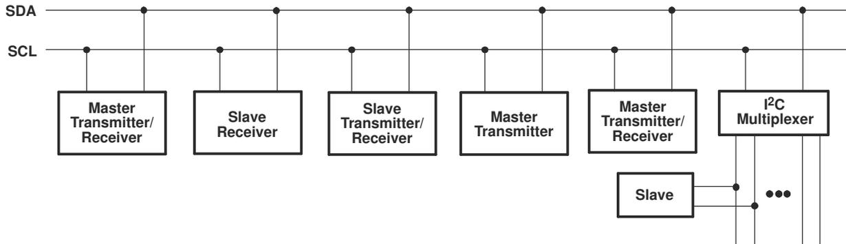
图 8-3. System Configuration
