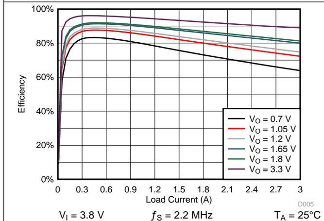
图 4-8. SMPS Efficiency for SMPS3 in PWM Mode
