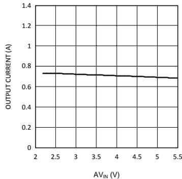
$V_{DDQ} = 2.5\text{ V}$        $PV_{IN} = 1.8\text{ V}$
