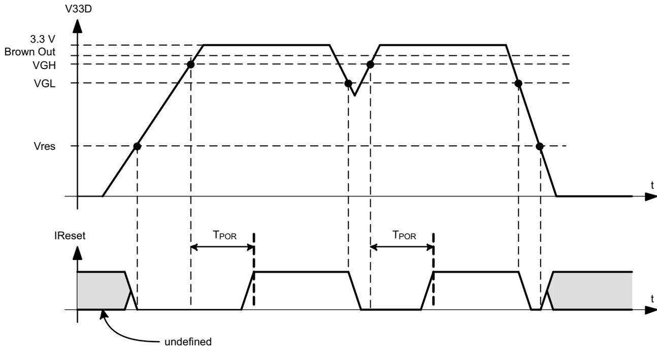
图 8-3. Power-On Reset (POR) and Brown-Out Reset (BOR)
