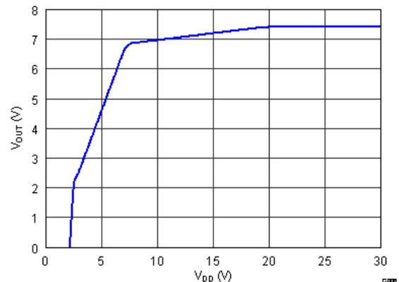
Figure 7-6. V<sub>OUT</sub> vs. V<sub>DD</sub>
